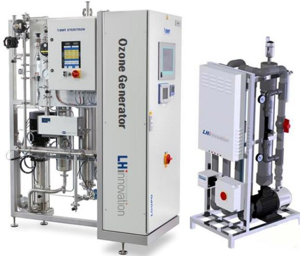
LH - Ozone generator 시스템은 공기중의 질소를 제거한 산소를 전극 사이에 방전관(유리, 세라믹)을 끼우고 그 방전관 안에 고압을 가함으로써 +와 - 전기 사이에 수많은 전기적 에너지들의 충돌을 인위적으로 유도하여 그 사이에 공기나 산소를 통과 시키면 O<sub>2</sub>가 전기적 에너지와의 충돌에 의해 O<sub>2</sub>가 O+O로 깨지며 일부 안깨진 O<sub>2</sub>와 합쳐져서 O<sub>3</sub>가 생성시키는 장치입니다
