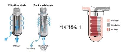
20μm 이상의 SS물질제거 및 내구성이 우수하여 여과판 교체 및 전력소모가 상대적으로 적다. UF, RO막 처럼 외압에 의한 세정이 아닌, 자동 역세척 또는 분리 후 세척한다
